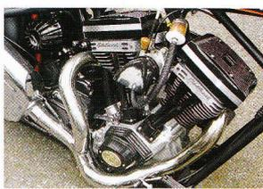
エーテルブロックが組み込まれたエポリユーションエンジンにはパウダーコートを施す。一風変わったエアクリナーにも注目だ!
