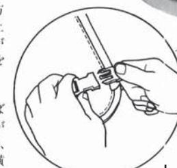
4 マウントにバッグ本体をセットすれば終了。なお、以上のような取りつけ方が不可能なときは、マウントの⑧、⑨、⑩のミゾを使って、ベルトをタンクの横から下にまわし、マウントを固定してください。
