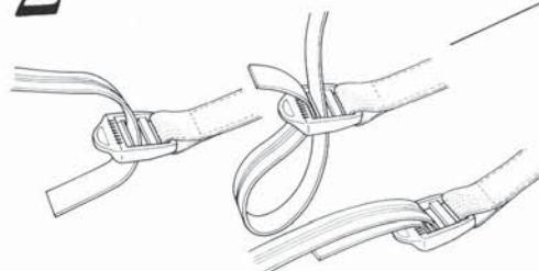
3 フレームにまわしたベルトを、マウントの後のバックル⑥、⑦に取りつけ(方法は②と同じ)、マウントをタンクの上にしっかりと固定します。もし、マウントがゆるいようなら、前後のベルトの長さを調整しなおしてください。
