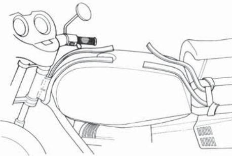
2 ステアリング・ヘッドの下にまわしたベルトを、マウントの前のバックル④、⑤に取りつけます。取りつけ方は下の図のように…。
